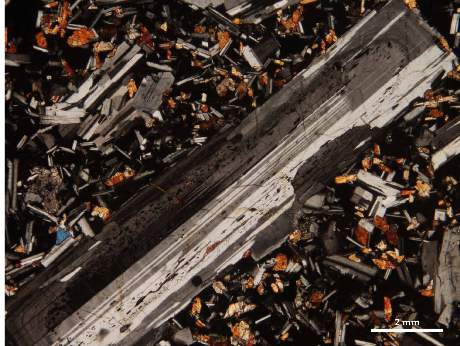
Plagioklász-kristályok andezitben Berről. Kőzettani fénymikroszkópi felvétel. Fotók: Gherdán Katalin
